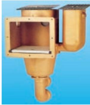
Über die Filterpumpe wird das Schwimmbeckenwasser vom **Oberflächenabsauger** abgesaugt, in der Filteranlage gereinigt und über die Einlaufdüsen wieder dem Schwimmbecken zugeführt. Der anmontierte **Wasserstandsregler** gewährleistet einen stets gleichbleibenden Wasserspiegel, da durch Verdunstung, Rückspülung etc., der Wasserverlust ausgeglichen werden muß.
