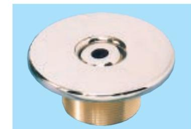
Über die **Einlaufdüsen** wird das gefilterte Wasser wieder zurück ins Schwimmbecken geleitet. Die Anordnung der Einlaufdüsen hat so zu erfolgen, daß eine vollständige und gleichmäßige Durchströmung in Richtung Oberflächenabsauger gewährleistet ist. Bei Freibecken ist zusätzlich die Haupt-Windrichtung zu berücksichtigen.
