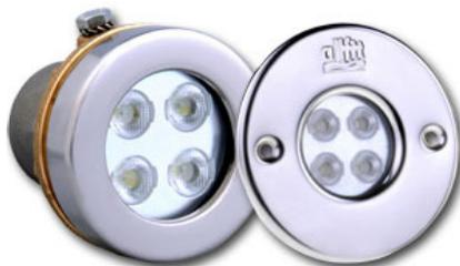
Auch die Leistung des Unterwasserscheinwerfers überzeugt mit 4 x 3 Watt und 90 Lumen. Der aus korrosionsbeständigem Rotguss oder Bronze und Edelstahl gefertigte Unterwasserscheinwerfer ist äußerst langlebig und mit einer 4 mm dicken Sicherheitsglasscheibe ausgerüstet. Mit dem im Lieferumfang enthaltenen 5m-Silikon-Kabel lässt er sich schnell und einfach in Fliesen-, Folien- und Fertigbecken installieren.
